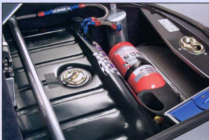
Le réservoir contient désormais 60 litres et son remplissage se fait par le coffre. Notez le petit réservoir tampon en alu, empêchant tout déjaugage intempestif.
