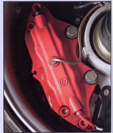
Les étriers arrière proviennent également d'une 993 Turbo. Vous avez dit surdimensionnés ?
