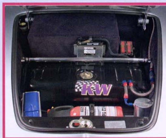
Le coffre regroupe le maximum d'éléments pour recentrer les masses : réservoir, extincteur, ampli et changeur CD, centrale ABS, etc.
