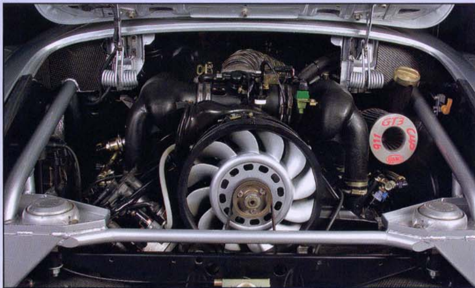
Le moteur est entré au chausse-pied grâce à de profondes modifications du châssis et de la cloison pare-feu. Notez, accolée à celle-ci sur la droite, la bache à huile du système de carter sec.
