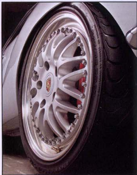
Les superbes jantes Speedline en trois parties chaussent des 215/40 et 245/35. Les quatre sont en 8 x 17 et déport ET49.
