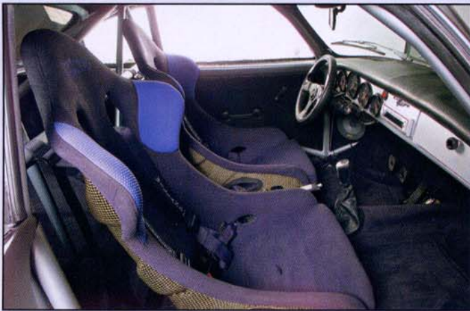
L'habitacle est envahi par l'arceau. Les baquets König sont en carbone-Kevlar.
