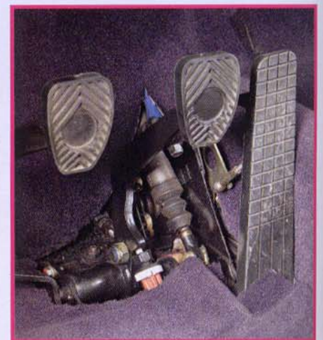
Le pédalier est lui aussi estampillé Porsche 993. Cela a permis de récupérer la commande hydraulique de l'embrayage.
