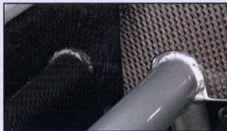
Servant de point d'ancrage aux suspensions, l'arceau sert aussi de support aux silentblochs moteur d'origine Porsche.
