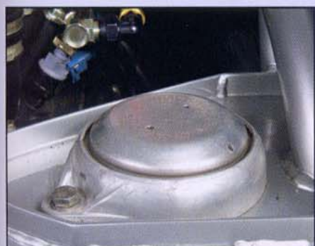
Pour les supports moteur-boîte, Jochen a utilisé du 993 d'origine. Ici, les supports arrière hydrauliques.
