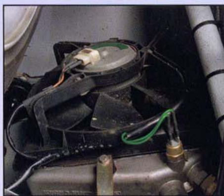
Deux radiateurs d'huile munis de ventilateurs prennent place derrière les ouïes de la face avant.
