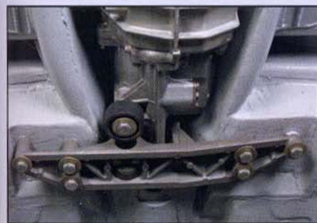
Le nez de boîte est supporté par la traverse 993, elle-même fixée sur le châssis profondément modifié et renforcé par l'arceau.
