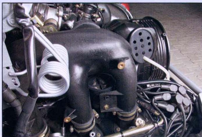
Le collecteur d'admission, même s'il n'est pas spécialement beau, est un modèle de 993 GT3 Cup!
