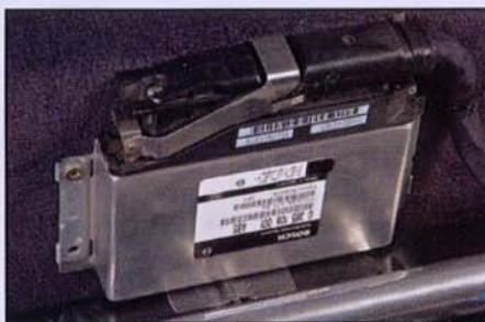
Le calculateur du système ABS est installé dans le coffre avant.
